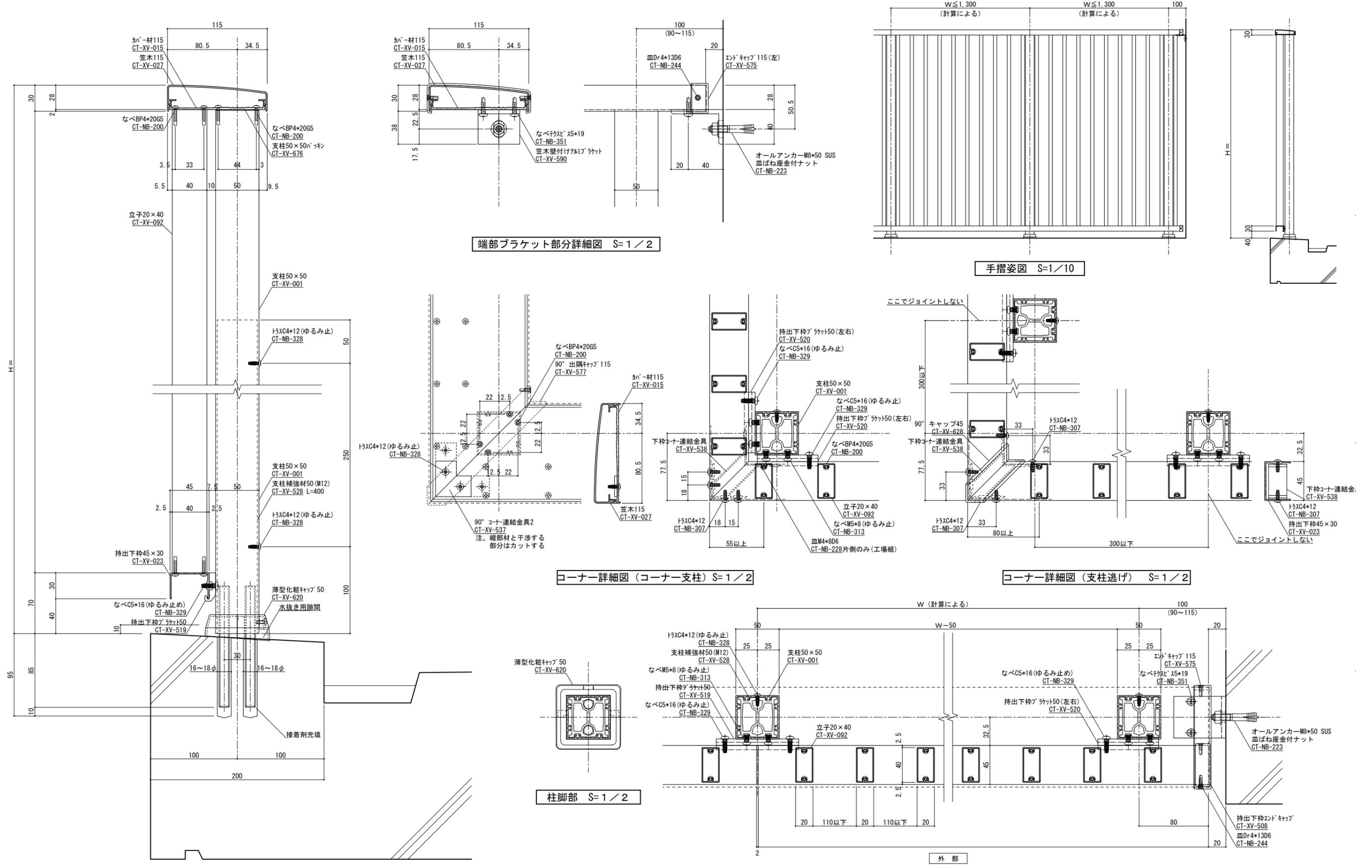
縦断面図 S=1/2 手摺埋め込み部と鉄筋が干渉しないよう躯体寸法、配筋位置を確認、設定してください 実際には施工誤差等が生じるため寸法に余裕を持たせる必要があります。
