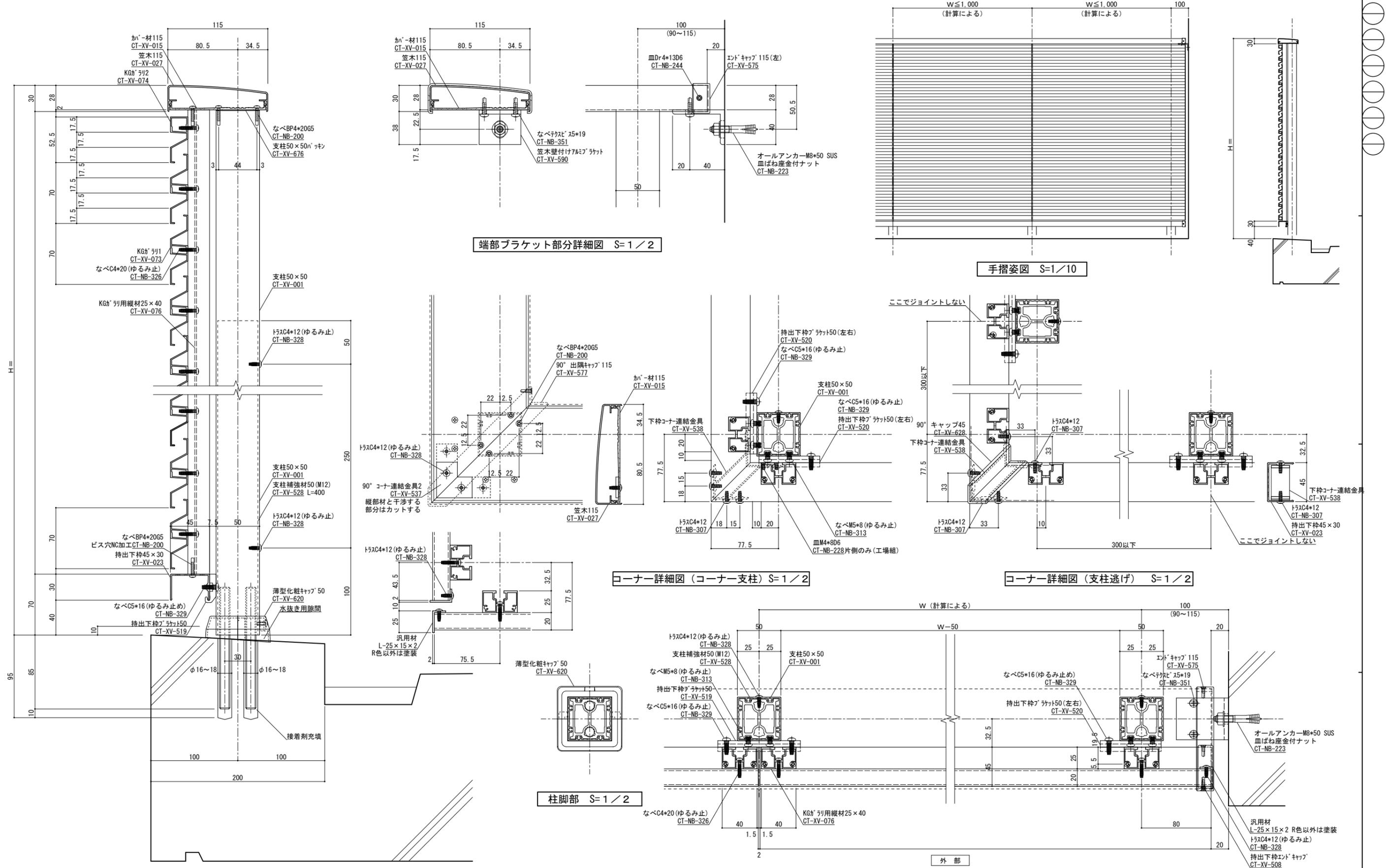
**縦断面図 S=1/2** 手摺埋め込み部と鉄筋が干渉しないよう躯体寸法、配筋位置を確認、設定してください
