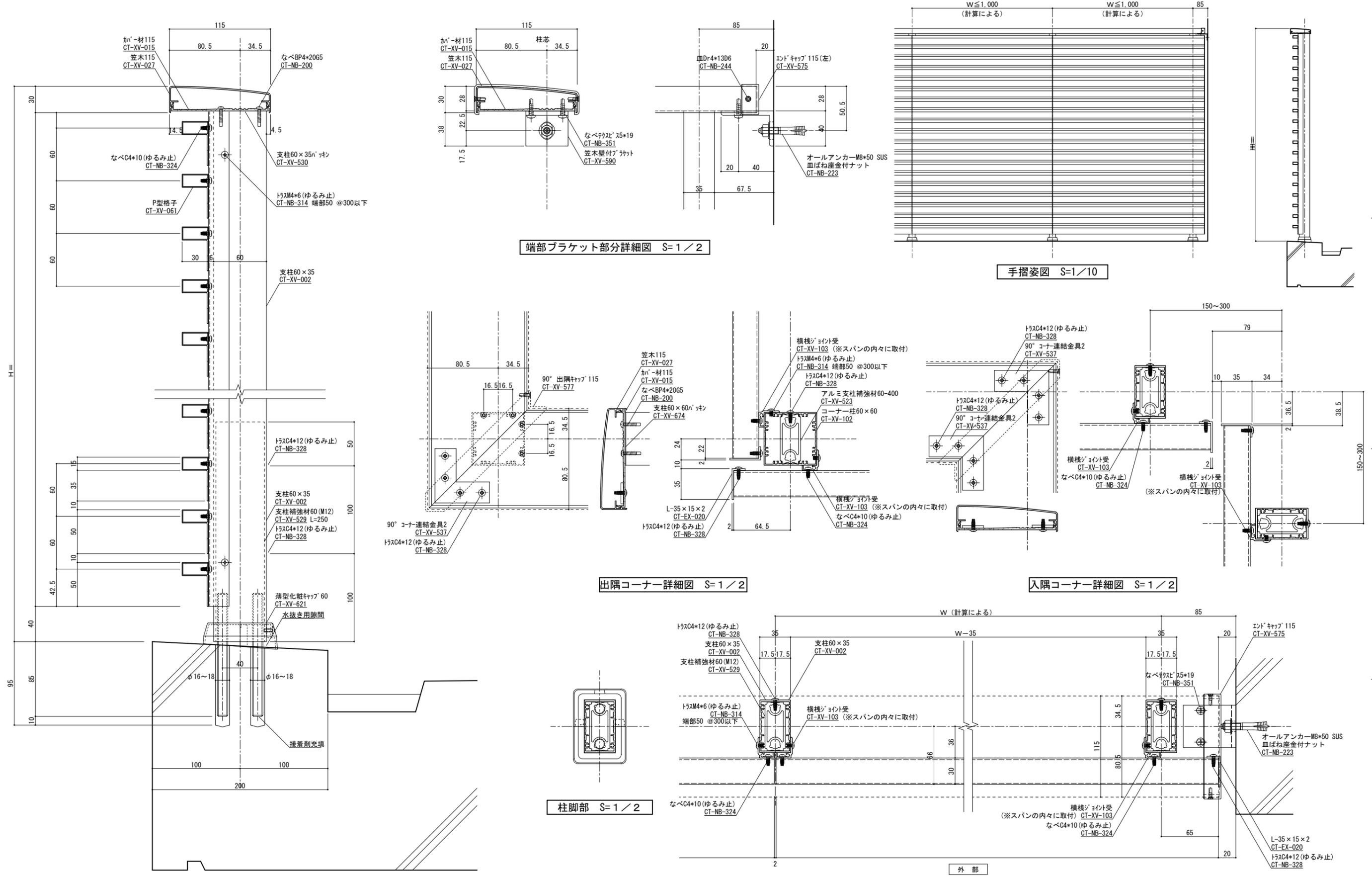
縦断面図 S=1/2 手摺埋め込み部と鉄筋が干渉しないよう躯体寸法、配筋位置を確認、設定してください。鉄筋とアンカーが干渉する場合は、鉄筋の切断を建築工事にてお願いします。予めご了承ください。
