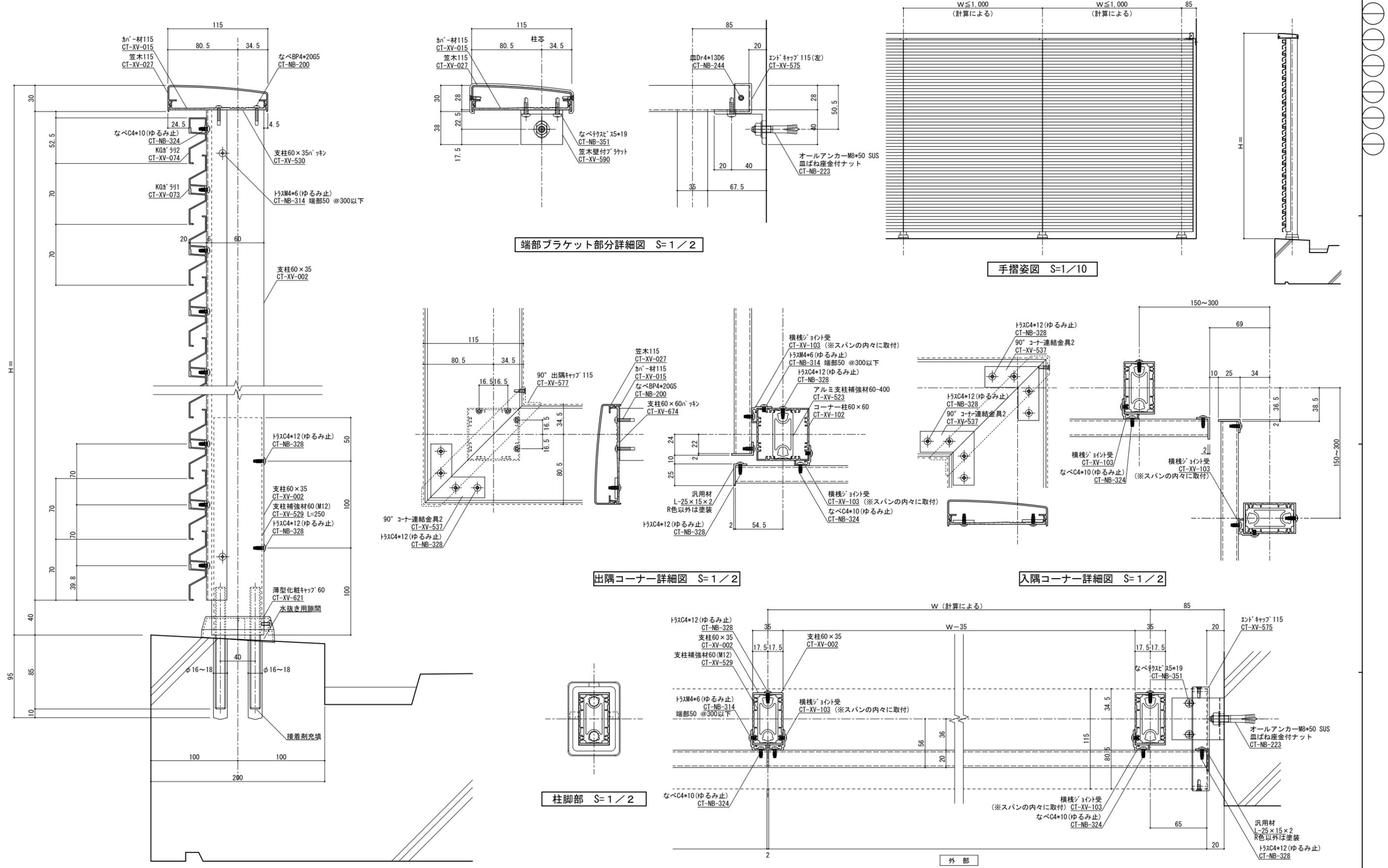
縦断面図 S=1/2 手摺埋め込み部と鉄筋が干渉しないよう躯体寸法、配筋位置を確認、設定してください。鉄筋とアンカーが干渉する場合、鉄筋の切断を建築工事にてお願いします。予めご了承ください。
