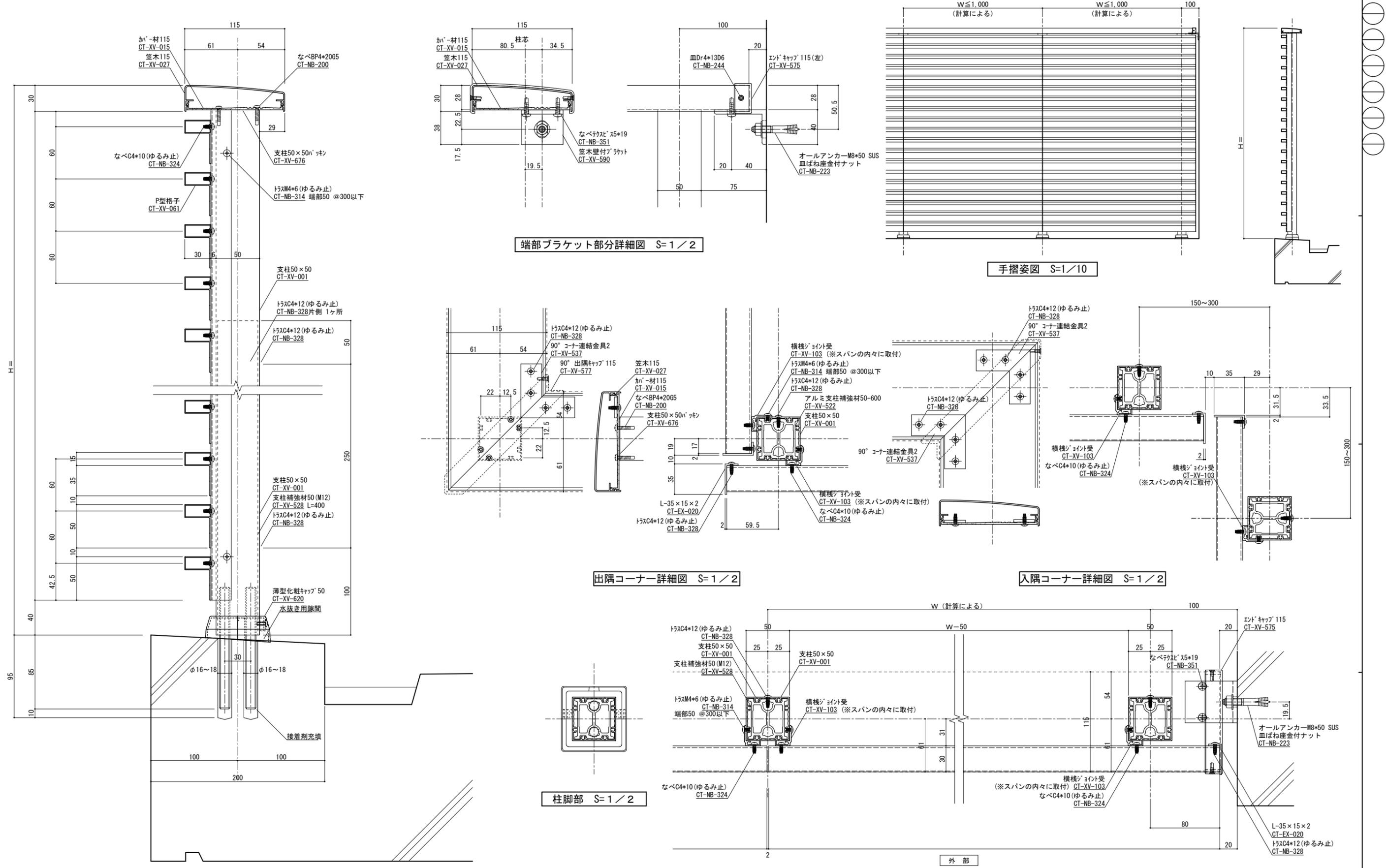
手摺埋め込み部と鉄筋が干渉しないよう躯体寸法、配筋位置を確認、設定してください
