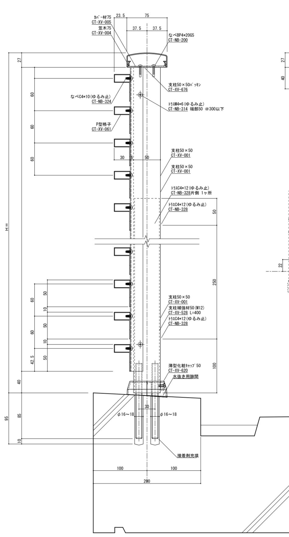
縦断面図 S=1/2 手摺埋め込み部と鉄筋が干渉しないよう躯体寸法、配筋位置を確認、設定してください。鉄筋とアンカーが干渉する場合、鉄筋の切断を建築工事にてお願いします。予めご了承ください。
