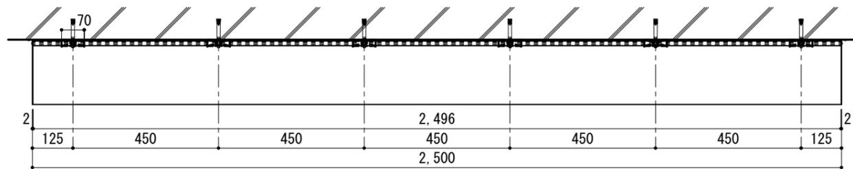
※下記割付は、ALC巾600mmが並列していることを条件としています。(アンカー位置はALC目地から100mm離して割付けて下さい。)
