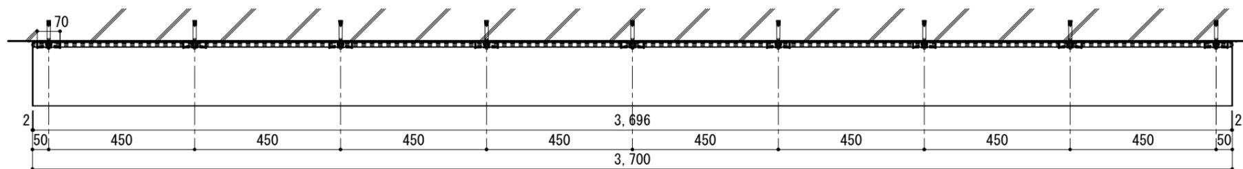
※下記割付は、ALC巾600mmが並列していることを条件としています。(アンカー位置はALC目地から100mm離して割付けて下さい。)
