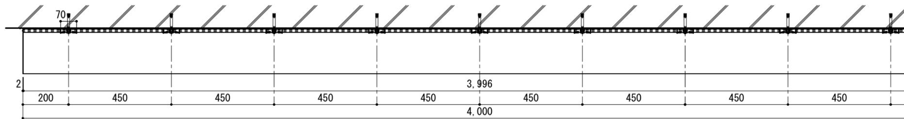
※下記割付は、ALC巾600mmが並列していることを条件としています。(アンカー位置はALC目地から100mm離して割付けて下さい。)
