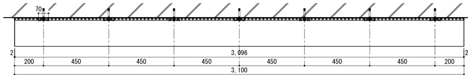
※下記割付は、ALC巾600mmが並列していることを条件としています。(アンカー位置はALC目地から100mm離して割付けて下さい。)
