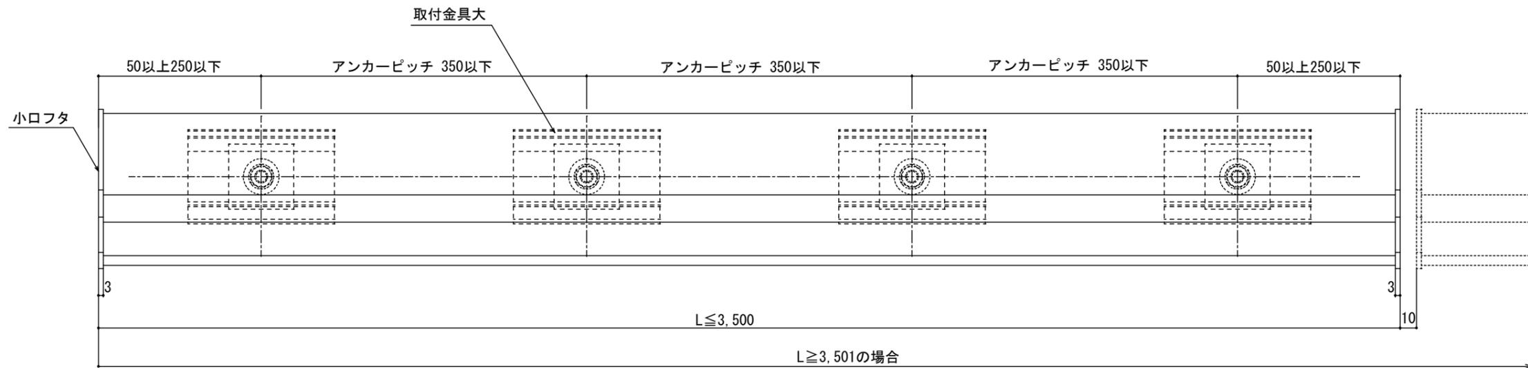
※底取り付け用の下地材は別途となります。下地材は建物本体柱・梁等にしっかり固定してください。取り付けられる壁の条件により、耐荷重性能が低くなります。
