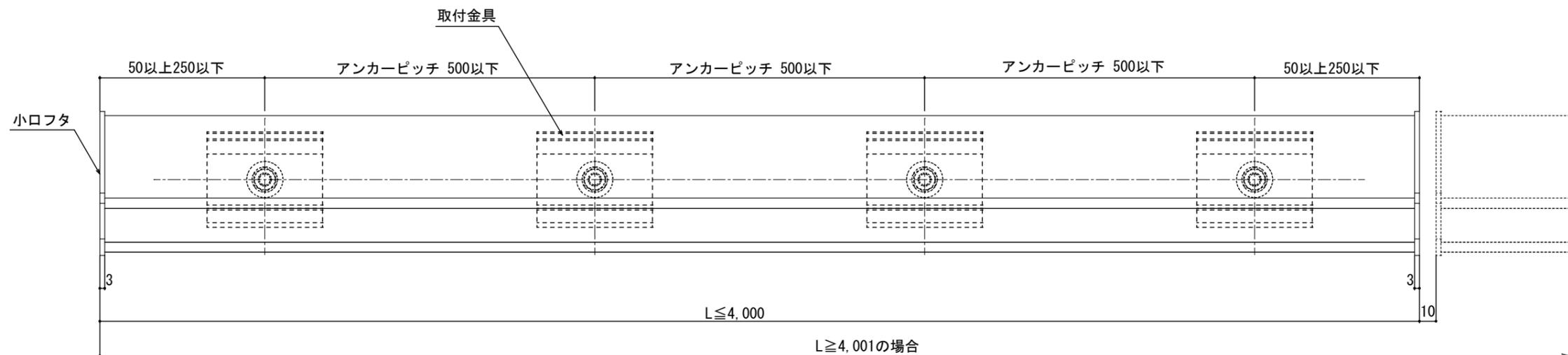
※底取り付け用の下地材は別途となります。下地材は建物本体柱・梁等にしっかり固定してください。取り付けられる壁の条件により、耐荷重性能が低くなります。
