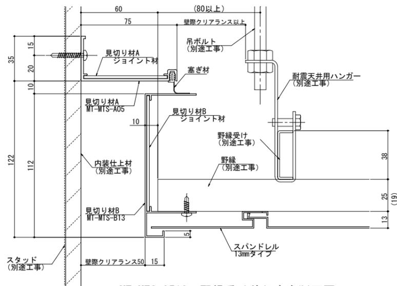
MT-MTS-0513 野縁受け並行方向断面図
