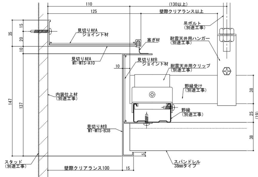
MT-MTS-1038 野縁受け直行方向断面図
