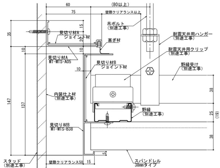
MT-MTS-0538 野縁受け直行方向断面図
