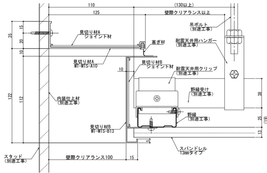
MT-MTS-1013 野縁受け直行方向断面図
