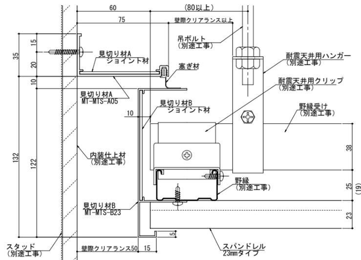
MT-MTS-0523 野縁受け直行方向断面図
