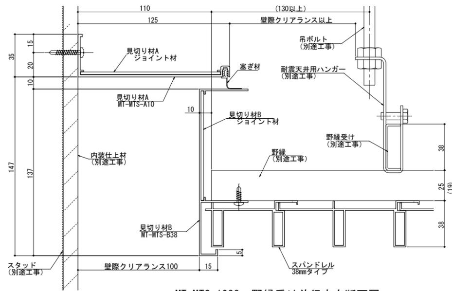
MT-MTS-1038 野縁受け並行方向断面図
